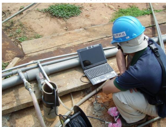
启动水位观测系统
