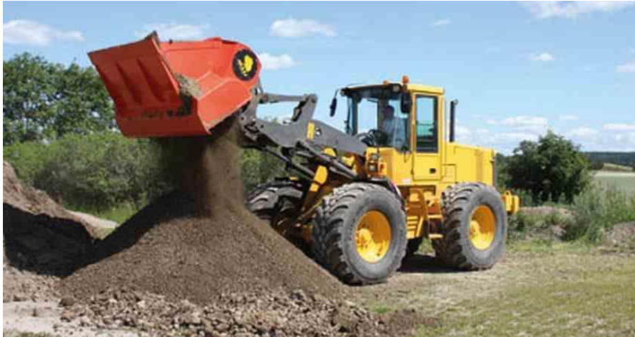
图 4.2.3-4 移动式筛分破碎铲斗示意图
