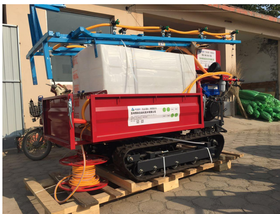
图4.6.1-1气味抑制剂喷洒设备
